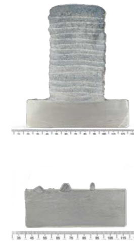
Rysunek 1. Proces napawania przyrostowego od pojedynczych ściegów do pełnego wydrukowanego bloku w 3D
