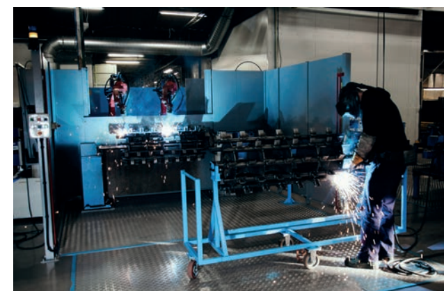
V době, kdy operátor čeká na svařovacího robota, provede mezitím manuální svařovací práci
