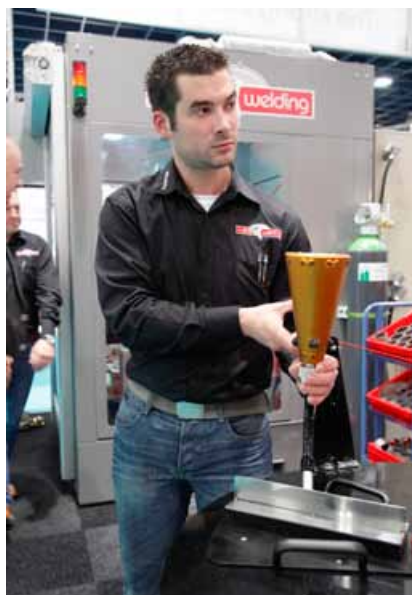
Svařč ved ruční nástroj ve správné poloze podél horizontálních švů
