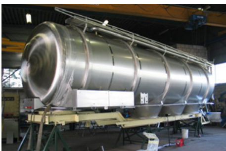
Die Flüssigkeitstanks aus Edelstahl, die Hazeleger mit der Längs- und Rundnahtschweißmaschine von ADK Technik automatisiert verschweißt.
