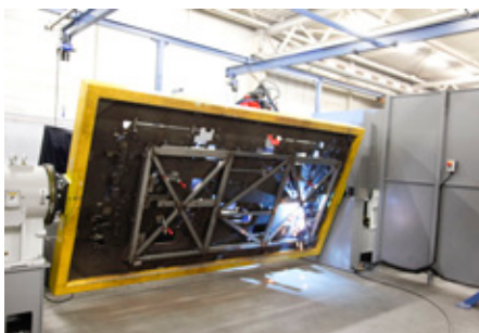
Tvärsnitten svetsas nu av svetsroboten....
