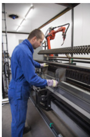
Lysdioder på mallen visar var operatören ska placera bärbalkarna
