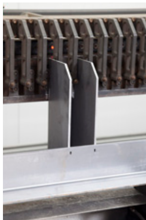
Lysdioder på mallen visar var operatören ska placera bärbalkarna
