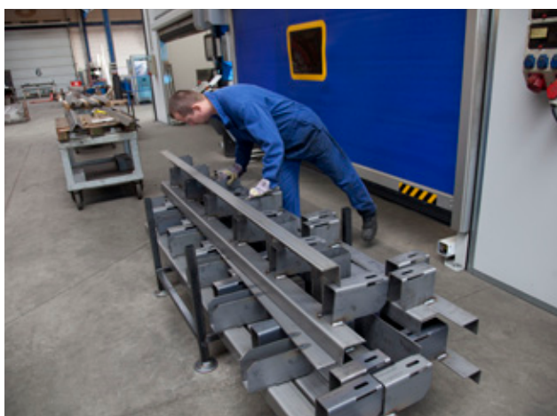
Bärbalkarna svetsas fast vid avväxlingsbalken utan att fästas först
