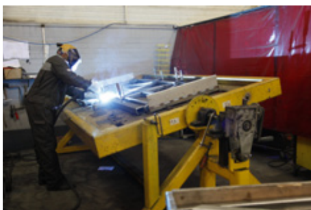
Tvärsnitten svetsades tills nyligen för hand.
