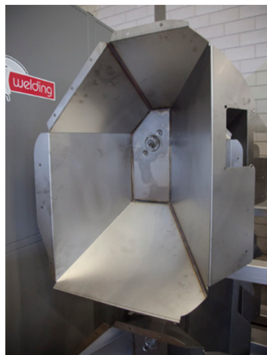
En rostfri produkt som är svetsad på utsidan och 100 % genomsvetsad på insidan.
