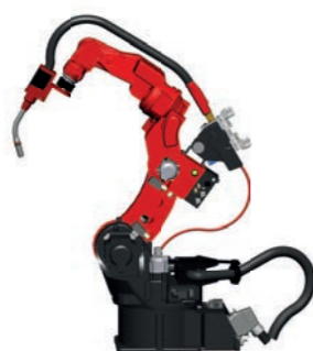
Externí kabelový svazek
