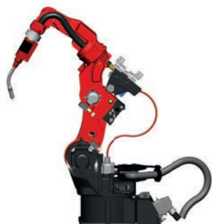
Interní kabelový svazek
