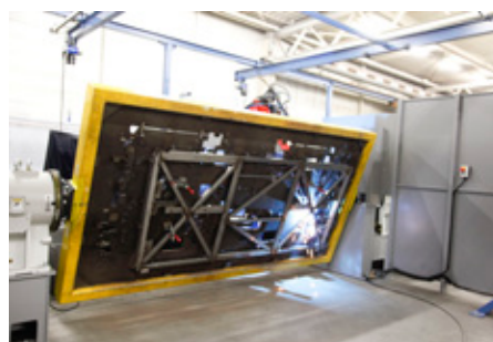
Tværsnittene færdigsvejses nu af svejserobotten....
