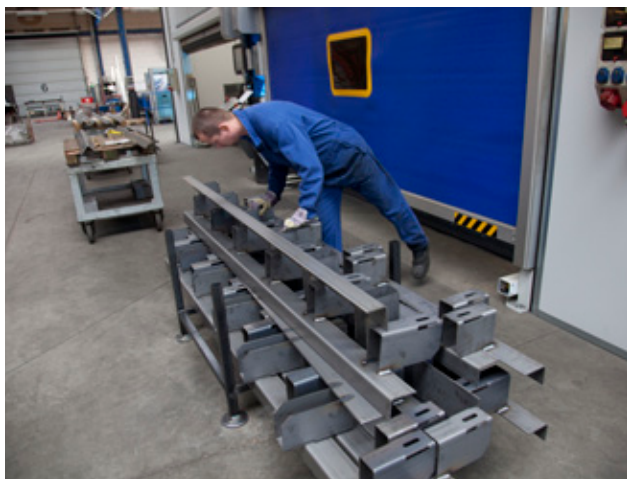
Bærerne påsvejses overliggerne uden forfiksering
