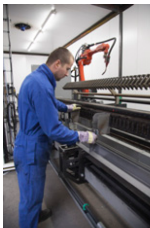
Lysdioder på fixturen viser, hvor operatøren skal anbringe bærerne
