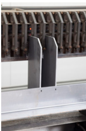
Lysdioder på fixturen viser, hvor operatøren skal anbringe bærerne
